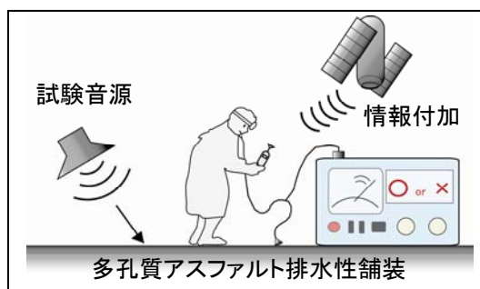
図. 道路路面の吸音率・空隙伝搬特性計測
